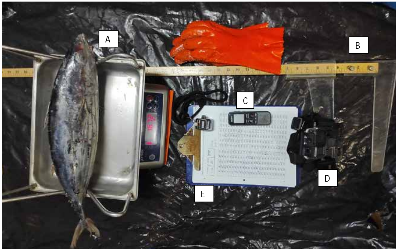
FIGURE 3. Sampler equipment: A) scale, B) caliper, C) voice recorder, D) GoPro camera, E) counting sheet. FIGURA 3. Equipo de muestreo: A) balanza, B) calibrador, C) grabadora de voz, D) cámara GoPro, E) hoja de conteo.
