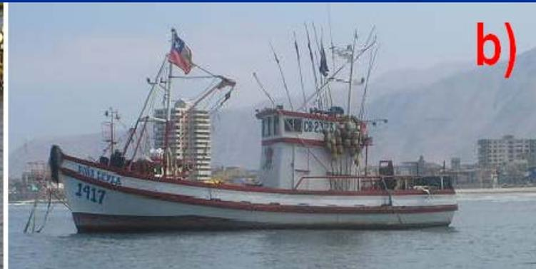
Figura 1. a) Lancha espinelera de menos de 12 metros de eslora b) Lancha espinelera de más de 12 metros de eslora.
